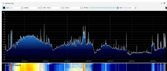
Рис.1. Візуалізація спектру програмою SpectrumSpy до увімкнення джерела НС
