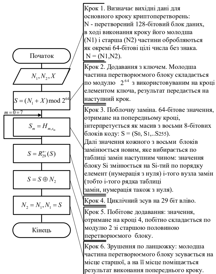
Рис.1. Схема основного кроку удосконаленого криптоперетворення ГОСТ 28147-89
